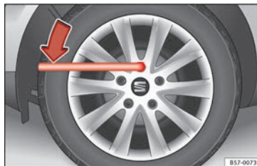
Fig. 81 Changement de roue : desserrer les vis de roue.
