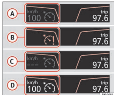
Fig. 180 Afficheur du combiné d'instruments indications d'état du GRA.
