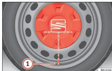
Fig. 76 Placement correct de l'enjoliveur central de roues pour jantes en acier.
