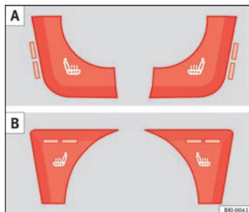
Fig. 150 Dans la console centrale : commandes du chauffage des sièges avant. A : version avec Climatronic. B : version avec climatiseur manuel.
