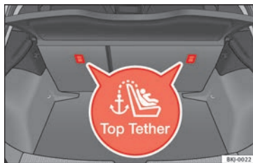
Fig. 32 Position des anneaux Top Tether sur la partie arrière de la banquette arrière.
