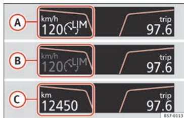
Fig. 181 Sur l'écran du combiné d'instruments : indications de l'état du limiteur de vitesse.
