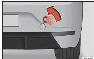
Fig. 86 Pare-chocs arrière droit : œillet de remorquage.
