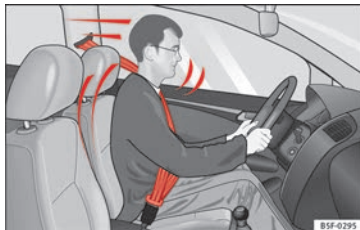
Fig. 98 Les conducteurs qui ont correctement bouclé leur ceinture de sécurité ne seront pas projetés en cas de freinage soudain.
