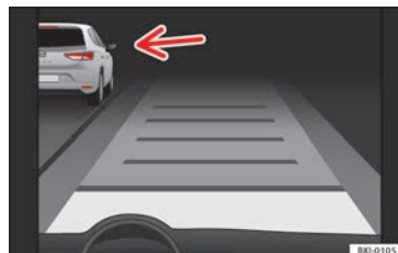
Fig. 195 Sur l'écran du combiné d'instruments : ACC activé, véhicule circulant à gauche détecté
