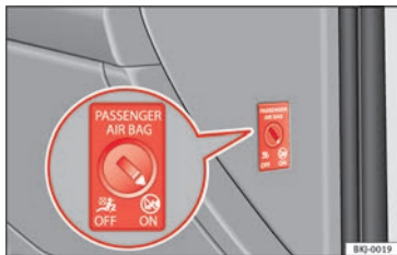
Fig. 103 Commande à clé permettant d'activer et de désactiver les airbags du passager avant.
