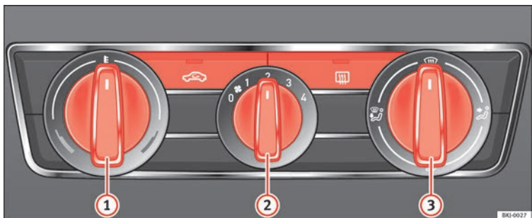
Fig. 62 Dans la console centrale : commandes du système de chauffage et d'air frais.
