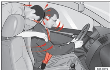
Fig. 100 L'occupant de la banquette arrière non attaché est projeté en avant et vient heurter le conducteur attaché.
