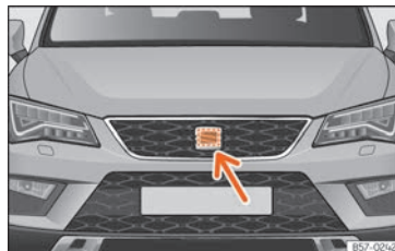
Fig. 255 Sur la face du véhicule derrière l'emblème SEAT : capteur radar.
