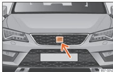
Fig. 260 Sur la face du véhicule derrière l'emblème SEAT : capteur radar.
