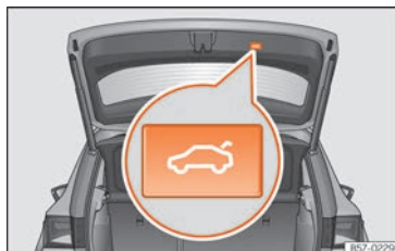
Fig. 145 Hayon arrière ouvert : touche de fermeture immédiate du hayon.
