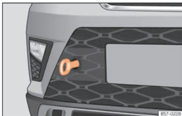
Fig. 80 Pare-chocs avant droit : œillet de remorquage vissé
