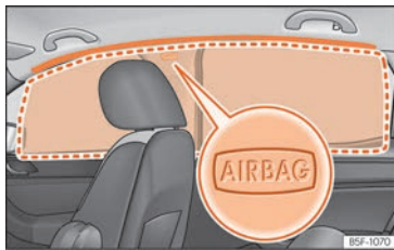
Fig. 34 Emplacement des airbags rideaux.
