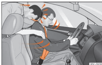
Fig. 95 L'occupant de la banquette arrière non attaché est projeté en avant et vient heurter le conducteur attaché.
