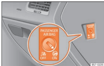
Fig. 98 Commande à clé permettant d'activer et de désactiver les airbags du passager avant.
