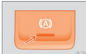
Fig. 249 Sur la partie inférieure de la console centrale : bouton de fonction Auto Hold.
