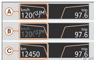
Fig. 251 Sur l'écran du combiné d'instruments : indications de l'état du limiteur de vitesse.
