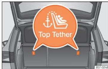
Fig. 40 Position des anneaux Top Tether sur la partie arrière de la banquette arrière.
