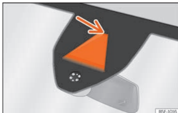
Fig. 266 Sur le pare-brise : fenêtre de l'assistant de maintien de voie.
