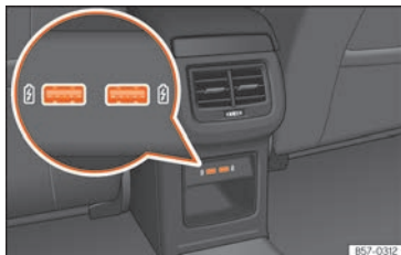
Fig. 237 Partie arrière de la console centrale : connecteurs USB.
