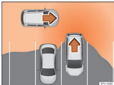
Fig. 275 Représentation schématique de l'assistant de sortie de stationnement : zone surveillée autour du véhicule sortant de stationnement.
