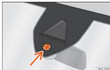
Fig. 157 Surface sensible du détecteur de pluie.
