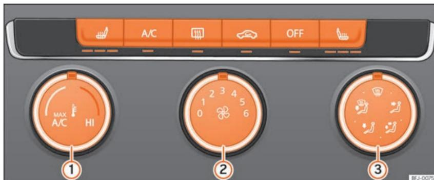
**Fig. 58** Dans la console centrale : commandes du climatiseur manuel.
