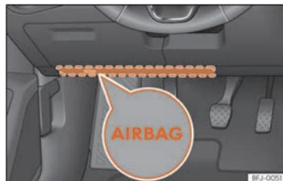
**Fig. 30** Côté conducteur : emplacement de l'airbag de genoux.
