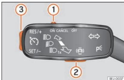
**Fig. 256** À gauche de la colonne de direction : commande et touches servant à utiliser le limiteur de vitesse.
