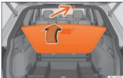
**Fig. 159** Dans le coffre à bagages : relever le plancher du coffre à bagages.
