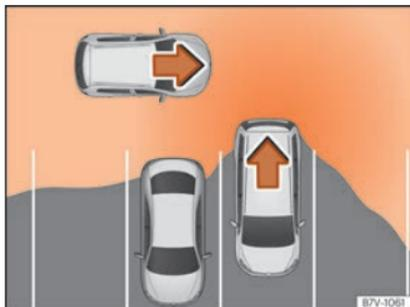
**Fig. 278** Représentation schématique de l'assistant de sortie de stationnement : zone surveillée autour du véhicule sortant de stationnement.
