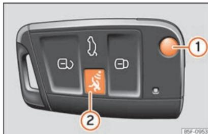
Fig. 118 Clé du véhicule avec bouton d'alarme.
