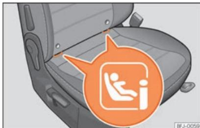
**Fig. 38** Siège passager avant : anneaux de fixation ISOFIX.
