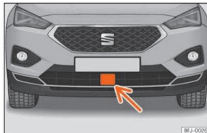
**Fig. 260** Au niveau du pare-chocs avant : capteur radar.
