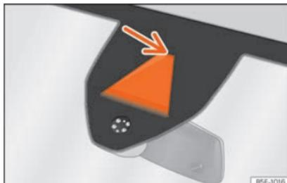
**Fig. 271** Sur le pare-brise : fenêtre de l'assistant de maintien de voie.
