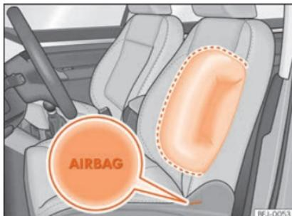
**Fig. 32** Airbag latéral dans le siège du conducteur.
