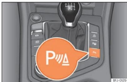
Fig. 287 Console centrale : touche de l'aide au stationnement.
