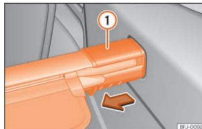
**Fig. 153** Dans le coffre à bagages : démonter la plage arrière du coffre à bagages. »
