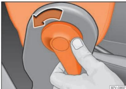
**Fig. 149** Débloquer le dossier rabattable du siège du passager avant.
