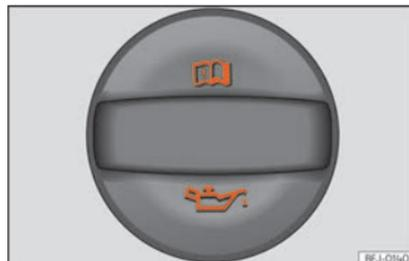
Fig. 306 Dans le compartiment-moteur : bouchon de l'orifice de remplissage d'huile moteur.
