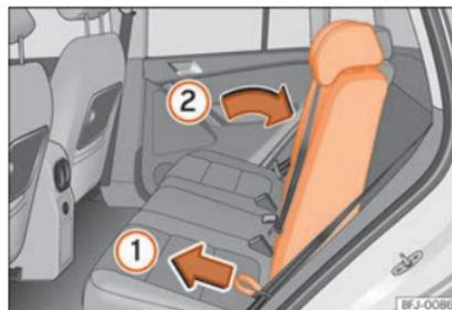
**Fig. 141** Réglage du dossier des sièges arrière.
