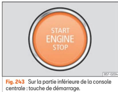
Fig. 243 Sur la partie inférieure de la console centrale : touche de démarrage.
