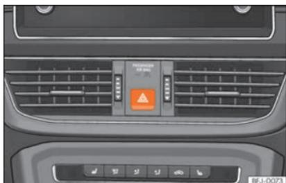
**Fig. 45** Planche de bord : commande des feux de détresse.
