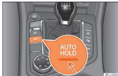
**Fig. 253** Sur la partie inférieure de la console centrale : bouton de fonction Auto Hold.
