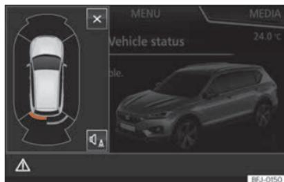
**Fig. 288** Indication en miniature de l'activation automatique
