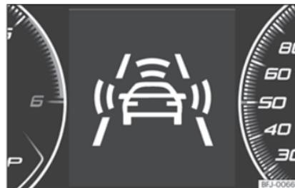
Fig. 259 Sur l'écran du combiné d'instruments : indications d'alerte préventive.
