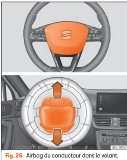
Fig. 26 Airbag du conducteur dans le volant.
