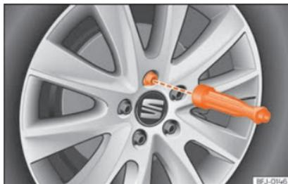
**Fig. 78** Roue : dévisser les boulons de la roue avec le manche du tournevis.
