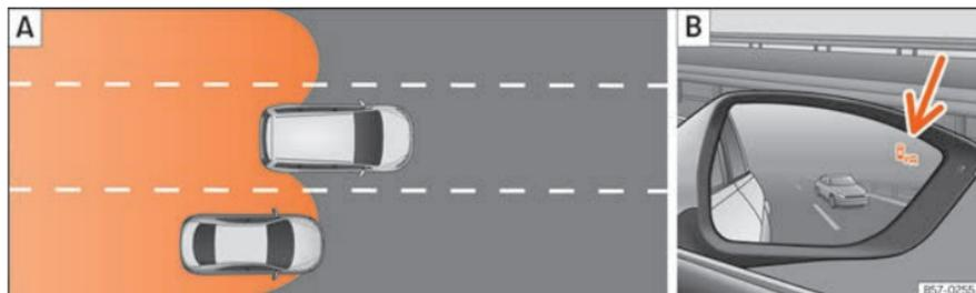
**Fig. 277** Représentation schématique : **A** En cas de dépassement puis de retour sur la voie de droite. **B** Indication de l'assistant d'angle mort sur le rétroviseur extérieur droit.
