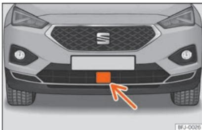
**Fig. 265** Au niveau du pare-chocs avant : capteur radar.
