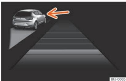
**Fig. 268** Sur l'écran du combiné d'instruments : ACC activé, véhicule circulant à gauche détecté
