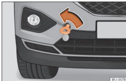
**Fig. 99** Du côté droit du pare-chocs avant : œillet de remorquage vissé
