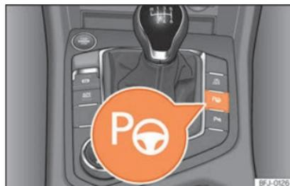
**Fig. 280** Sur la console centrale supérieure : touche permettant de connecter le système de stationnement assisté.
