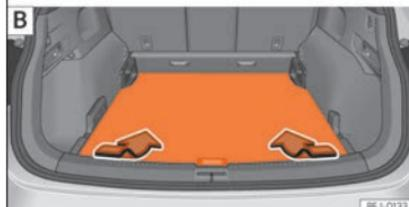
**Fig. 160** Dans le coffre à bagages : régler le plancher modulable du coffre à bagages en hauteur.
