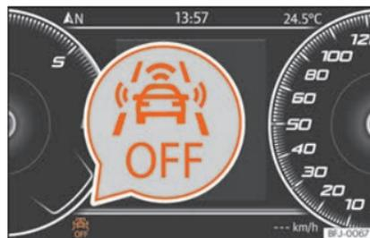
**Fig. 261** Sur l'écran du combiné d'instruments : indication de Front Assist désactivé.
