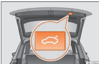
Fig. 10 Hayon : touche de fermeture du hayon
