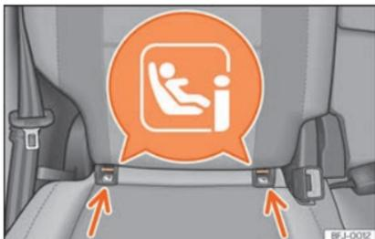
**Fig. 37** Sièges latéraux de la seconde rangée : anneaux de fixation ISOFIX/i-Size.
