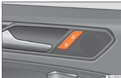
**Fig. 5** Porte du conducteur : commande de verrouillage centralisé.
