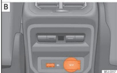
**Fig. 183** [A] Console centrale : prise de courant de 12 volts avant. [B] Partie arrière de la console centrale : prises de courant USB et de 12 volts.
