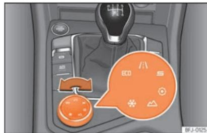
Fig. 279 Console centrale : Commande rotative (Driving Experience button).
