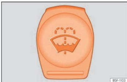
**Fig. 64** Dans le compartiment moteur : bouchon du réservoir de liquide lave-glace.
