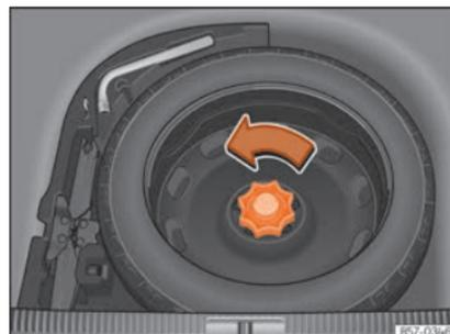
**Fig. 311** Roue de secours : plancher de chargement soulevé.
