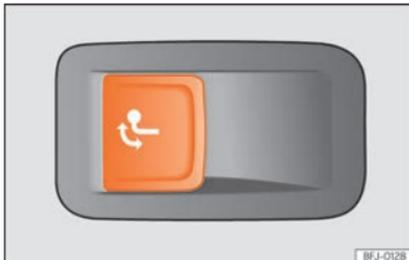
**Fig. 298** Sur le côté gauche du coffre à bagages : touche de déverrouillage de la boule d'attelage.
