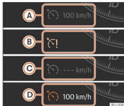
**Fig. 254** Afficheur du combiné d'instruments indications d'état du GRA.
