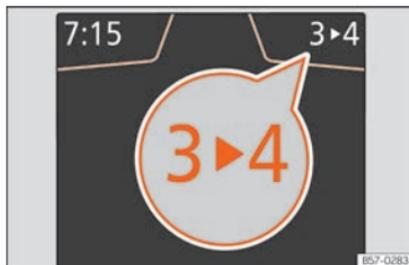
**Fig. 250** Combiné d'instruments : indicateur du rapport le plus économique (boîte mécanique)
