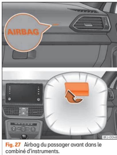
Fig. 27 Airbag du passager avant dans le combiné d'instruments.
