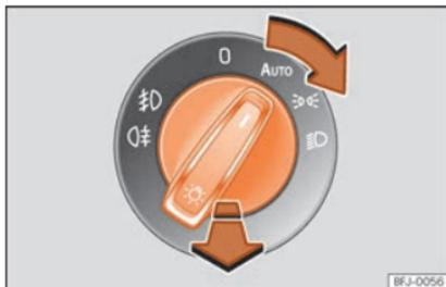
Fig. 43 Planche de bord : commande des feux.
