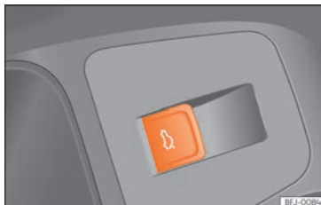
Fig. 126 Sur la porte du conducteur : touche d'ouverture et de fermeture du hayon arrière.
