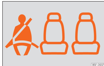
Fig. 88 Combiné d'instruments : indication de place arrière gauche occupée et de ceinture correspondante bouclée.
