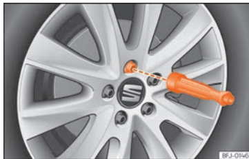
Fig. 78 Roue : desserrer les boulons de la roue avec le manche du tournevis.
