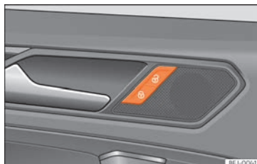
Fig. 5 Porte du conducteur : commande de verrouillage centralisé.
