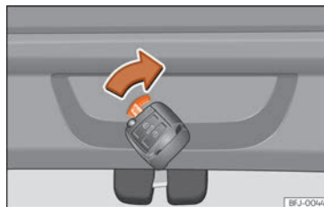
Fig. 11 Coffre à bagages, côté droit : déverrouillage d'urgence.
