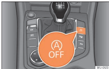
Fig. 250 Console centrale : touche du système Start-Stop.
