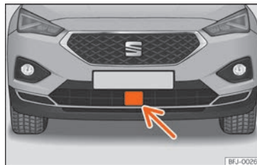
Fig. 259 Au niveau du pare-chocs avant : capteur radar.
