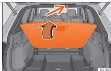
Fig. 159 Dans le coffre à bagages : redressement du plancher de coffre.
