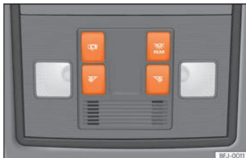
Fig. 46 Détail du ciel de pavillon : plafonnier avant.
