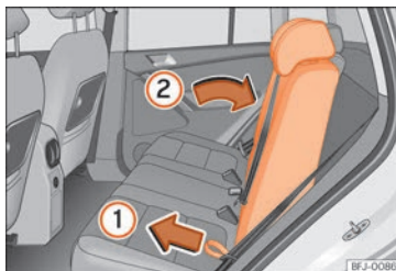
Fig. 141 Réglage du dossier de la banquette arrière.
