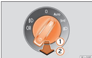
Fig. 132 Planche de bord : commande des feux.
