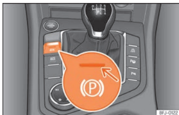
Fig. 246 Sur la partie inférieure de la console centrale : touche du frein de stationnement électronique.
