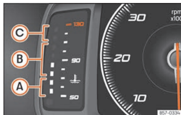
Fig. 113 Indicateur de température du liquide de refroidissement du moteur.
