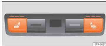
Fig. 189 Sur la console centrale arrière : commandes de chauffage des sièges arrière.
