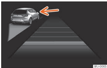
Fig. 267 Sur l'écran du combiné d'instruments : ACC activé, véhicule circulant à gauche détecté
