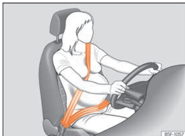
Fig. 93 Ajustement recommandé de la sangle de ceinture de sécurité pour les femmes enceintes.
