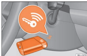
Fig. 244 À droite de la colonne de direction : démarrage d'urgence.
