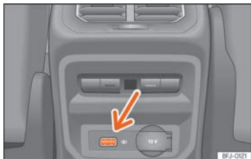
Fig. 240 Partie arrière de la console centrale : connecteurs USB.
