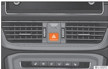
Fig. 134 Planche de bord : commande des feux de détresse.
