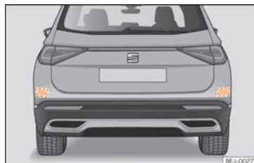
Fig. 274 Vue arrière du véhicule : zones des capteurs radars.
