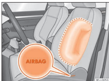
Fig. 32 Airbag latéral dans le siège du conducteur.
