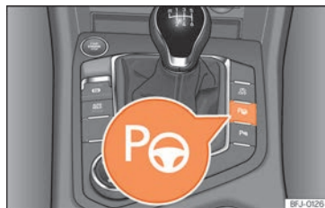
Fig. 279 Sur la console centrale supérieure : touche permettant de connecter le système de stationnement assisté.
