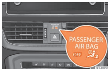
Fig. 96 Planche de bord : témoin de désactivation de l'airbag du passager avant.
