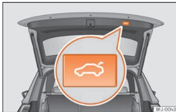
Fig. 125 Hayon arrière ouvert : touche de fermeture immédiate du hayon.
