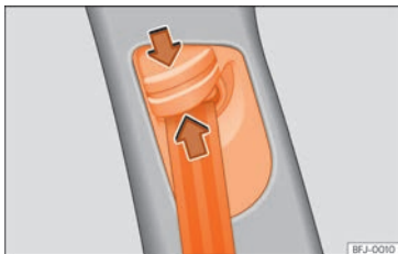
Fig. 94 Près des sièges avant : dispositif de réglage en hauteur de la ceinture.
