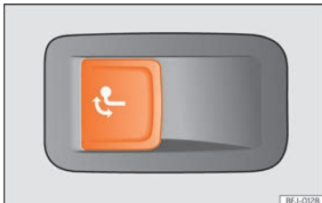
Fig. 297 Du côté gauche du coffre : touche de déverrouillage de la boule d'attelage.
