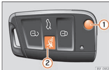
Fig. 118 Clé du véhicule avec bouton d'alarme.
