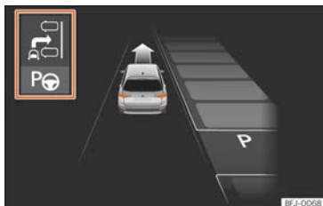
Fig. 281 Sur l'écran du combiné d'instruments : affichage du système de stationnement assisté avec affichage réduit.
