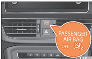
Fig. 29 Planche de bord : témoin de désactivation de l'airbag du passager avant.
