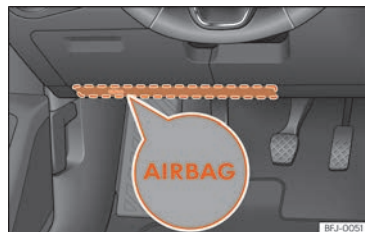
Fig. 30 Côté conducteur : emplacement de l'airbag de genoux.
