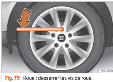
Fig. 75 Roue : desserrer les vis de roue.
